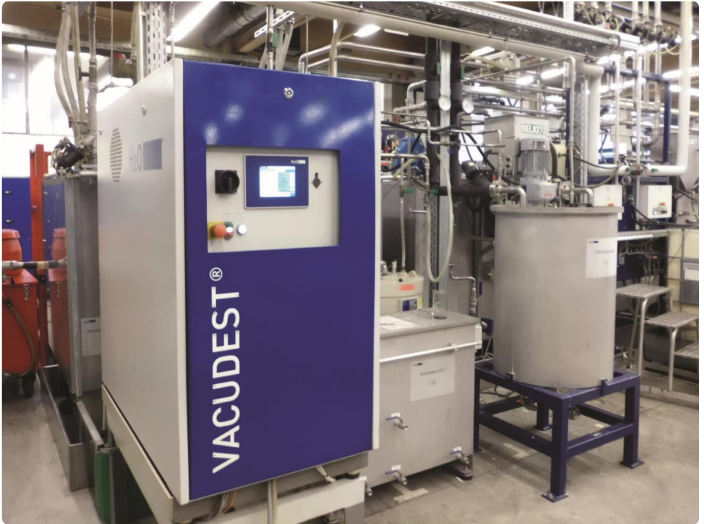
VACUDEST XS 帮助位于兰茨贝格的伊维斯实现零部件清洗水的回用。
