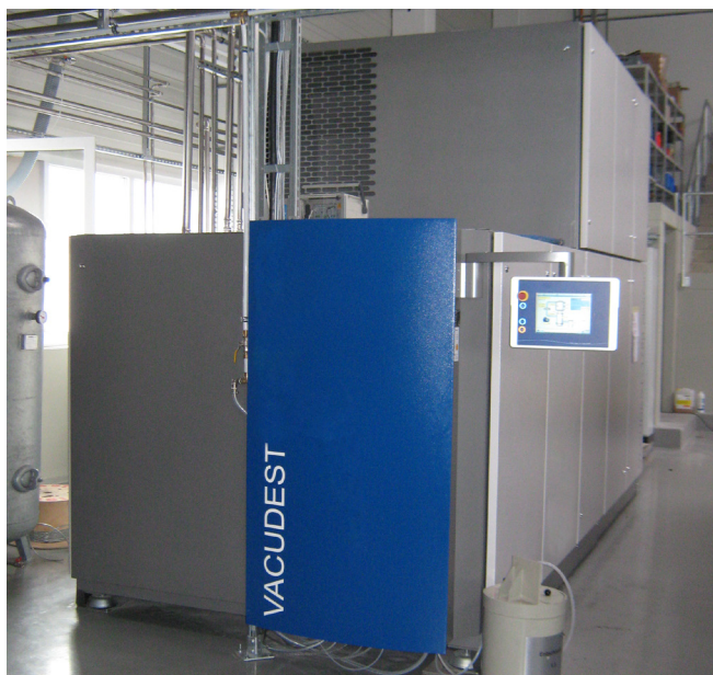
VACUDEST XL配备了集成式Clearcat模块，能确保低于20 mg/l的碳氢化合物极限值。
